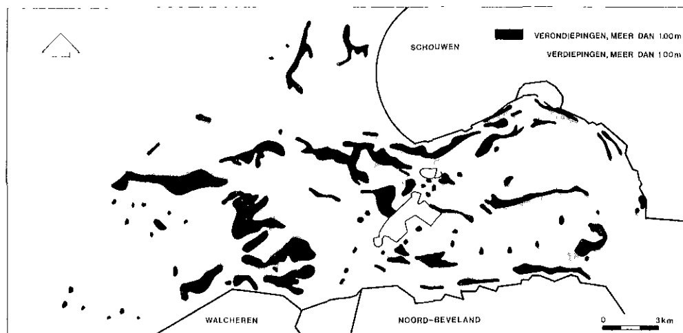
Fig 2 en 3. Verdiepingen en verondiepingen tussen 1973 en 1977, groter dan 30 cm (boven) en groter dan 1 m.
